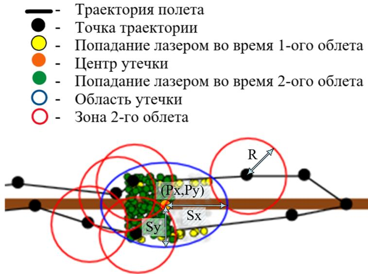
Рис. 7. Результат построения зоны облета БПЛА и выделения области утечки
