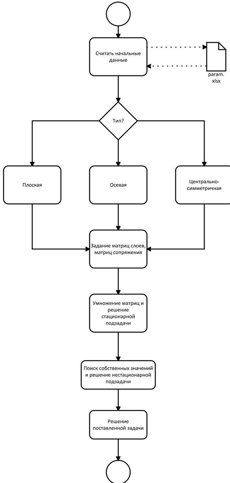
**Рис. 2.** Схема работы расчетного модуля «Нестационарная неидеальный контакт»
