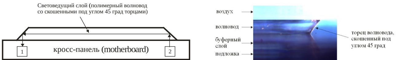
Рис. 7. (а) Схема волновода со скошенными под углом 45 градусов торцами для стыковки его с фотоприемниками (1) и излучателями (2). (б) Фотография изготовленного полимерного волновода со скошенным торцом
