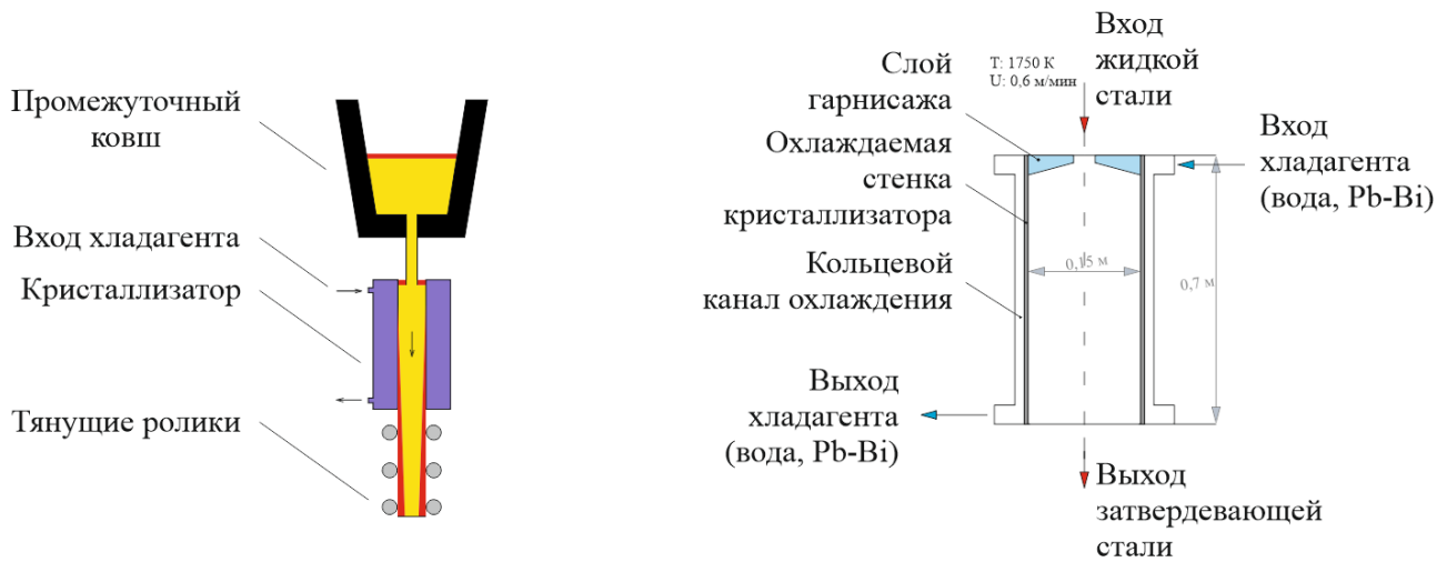
Рис. 2. Конструкция МНЛЗ и общий вид расчетной модели кристаллизатора
